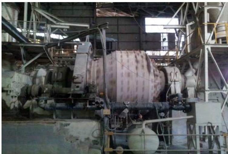
[그림 2-4] 혼합된 원료를 분쇄기로 분쇄하여 조립기로 이송
