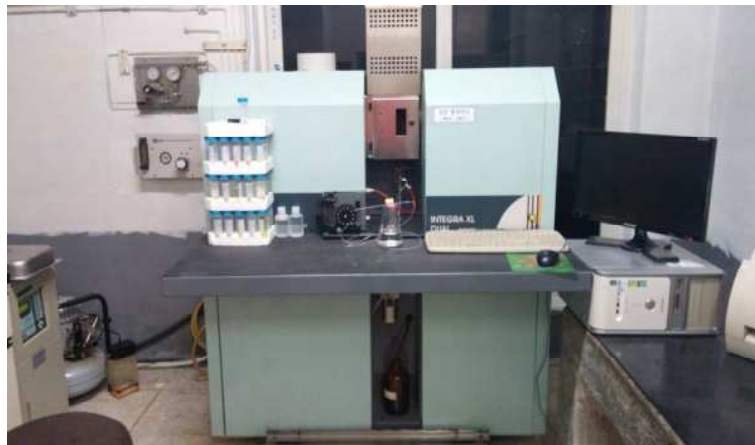
[그림 2-13] 제4종 복합 비료 원료 정량 분석 기기
