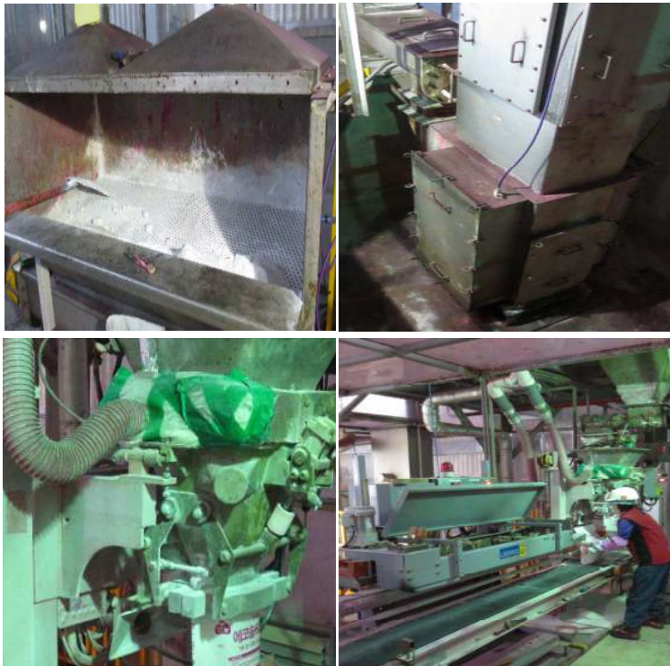
[그림 2-12] 제4종 복합비료 분상 제조 연속공정
